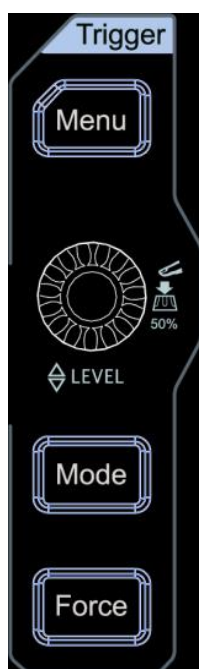
Rys. 1.5. Blok układu wyzwalania oscyloskopu cyfrowego Rigol MSO5204
