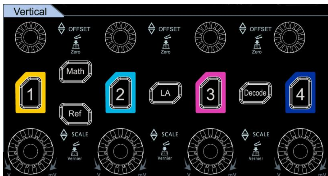
Rys. 4.3. Blok toru Y oscyloskopu cyfrowego Rigol MS05204
